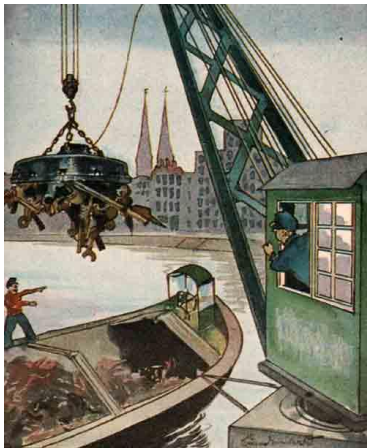
Abbildung 1: Schrott wird mithilfe eines Elektromagneten verladen.
