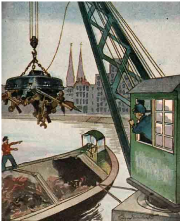
Abbildung 1: Schrott wird mithilfe eines Elektromagneten verladen.
